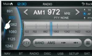
Пример: на рисунке выбран диапазон AM1, выбрана вторая по счету станция на частоте 972 кГц.
