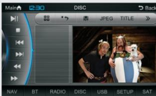
Из режимов Радио / AV / iPod / ТВ устройство автоматически перейдет в режим воспроизведения DVD после того, как вы вставите диск в головное устройство.
