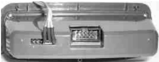
Подключите информационный провод для связи с парктроником "Multitronics" к трем контактам дополнительного 6-и контактного разъема маршрутного компьютера **Multitronics SE-50, SL-50, SE-50V, SL-50V** (2, 3, 4 контакты считая сверху) с соблюдением полярности подключения.
