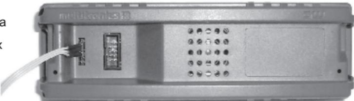
Подключите информационный провод для связи с парктроником "Multitronics" к трем контактам дополнительного 6-и контактного разъема маршрутного компьютера **Multitronics X140 / X150** (2, 3, 4 контакты считая сверху) с соблюдением полярности подключения.
