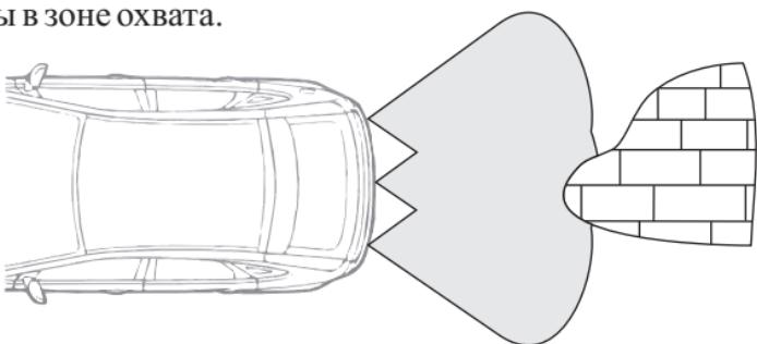
На дисплее маршрутного компьютера **Multitronics** отображается расстояние от препятствия до каждого из датчиков и звучит предупреждающий тональный сигнал / зуммер либо голосовое сообщение о приближении к препятствию.
