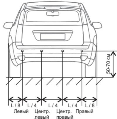
Сверлом, входящим в комплект парктроника, просверлите отверстия в отмеченных местах.
