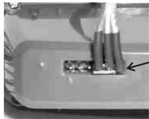
Маркированная сторона разъема парктроника должна быть обращена в сторону основного разъема МК.
