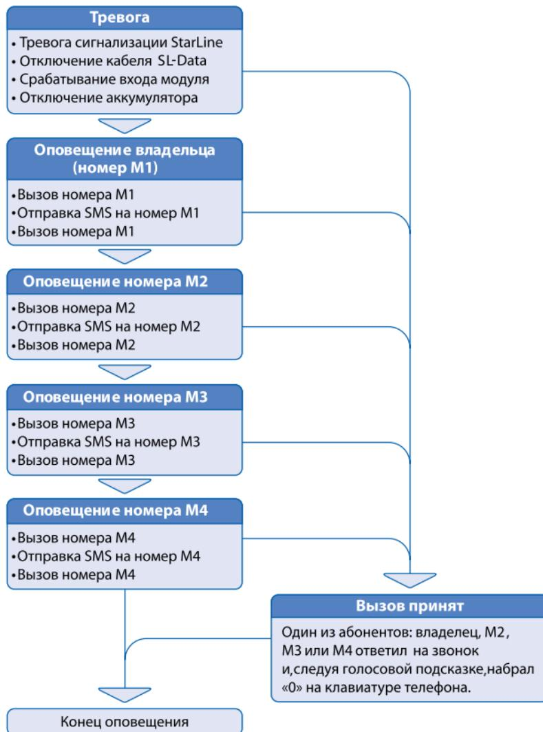
В случае срабатывания сигнализации StarLine, другой автосигнализации, подключенной к модулю, или самого модуля StarLine M21, M31, на записанные в память модуля номера, рассылаются оповещения о тревоге с указанием причины срабатывания. В случае получения звонка о тревоге сигнализации, владелец, следя голосовой подсказке, должен нажать клавишу «0» на своем телефоне. Это нажатие подтверждает прием голосового сообщения о тревоге и отменяет последующие попытки дозвона и отправку SMS.
