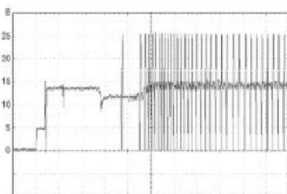
Момент прекращения прокручивания стартера автосигнализация определяет по резкому возрастанию частоты сигнала в момент начала работы двигателя. Подключение сине-красного провода к такой цепи гарантирует правильное отключение стартера.
