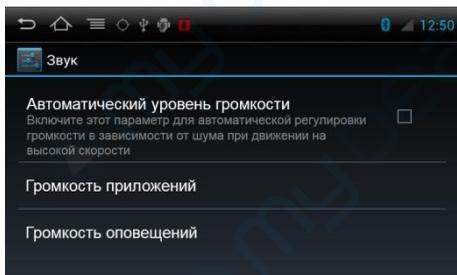
**Автоматический уровень громкости** – автоматическая регулировка громкости в зависимости от скорости движения автомобиля;
